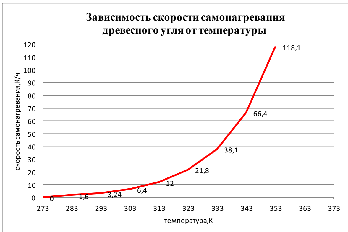
Рисунок 1.3. Зависимость скорости самонагрева древесного угля от температуры
